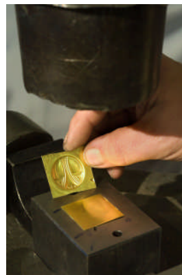
Rekonstruktion einer Medaillonseite über das Hohlprägeverfahren mit dem Fallhammer in der Abt. „Manufaktuelle Schmuckproduktion“ des DTMB im Jahr 2007, Foto: © C. Kirchner, DTMB
